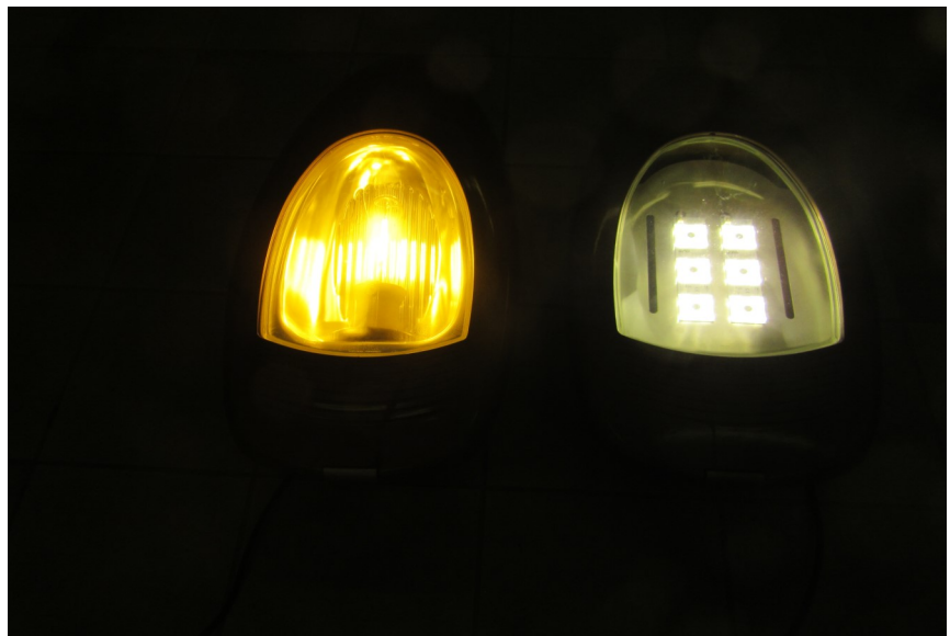
Lampe sodium SHP 150W (lumière jaune) Lampe reconfigurée 53W LED (lumière blanche)
